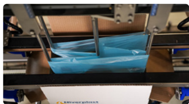
4 Extendido de bolsas y fuelle
